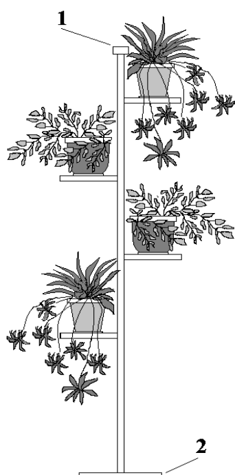
Рисунок 1- Конструкция для размещения комнатных растений с фиксацией к стене -1 и полу-2
